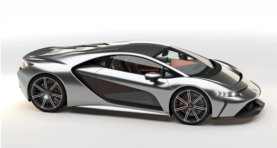
Nur 33 GB110 sollen gebaut werden. Für das von einem Verbrennungsmotor angetriebenen Hypercar werden Leistungswerte von über 1100 PS und 1100 Nm Drehmoment kolportiert. Auch das Fahrverhalten wurde aufwändig ausgelegt, mit Einzelradaufhängungen an doppelten Querlenkern und 4-facher Dämpfungseinstellung, die es dem Fahrer ermöglicht, das Fahrzeug für alle möglichen Einsatzzwecke individuell einzustellen.
