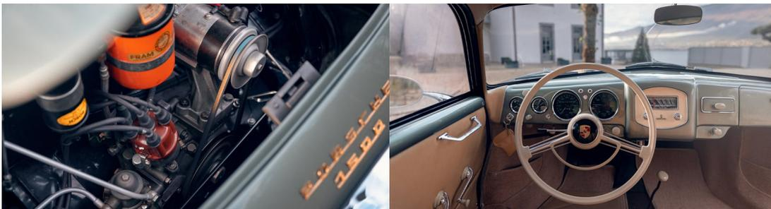
Die frühen 356er hatten noch eine zweigeteilte Windschutzscheibe. Im April 1952 wich sie einer einteiligen, leicht gebogenen Scheibe, die in die identische Aussparung passte. Ein zeitloses Design, das gekrümmte Windschutzscheiben vorwegnahm und zum ganz speziellen Charme dieser frühen Produkte aus Zuffenhausen beitrug.
