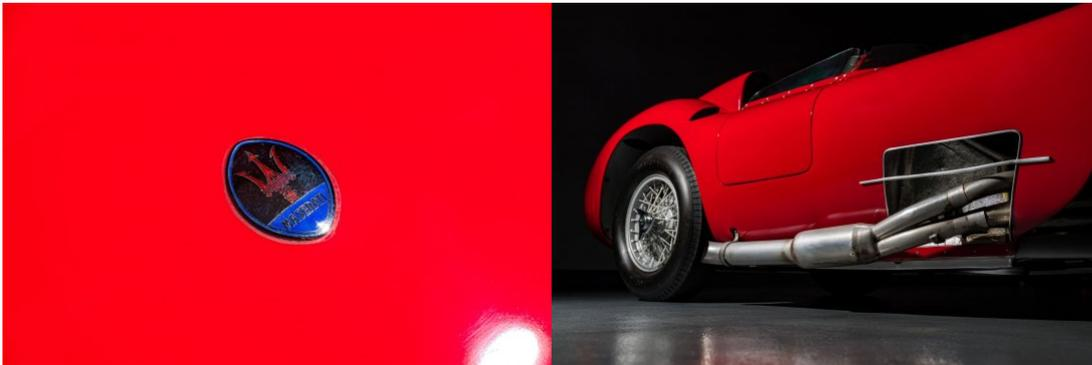
Mit dem feuerspeienden 450S stimmte Maserati in den fünfziger Jahren den Abgesang auf den Motorsport an. Entwickler Guido Taddeucci schuf ein Fahrwerk sowie Getriebe, die den 400 PS des markeneigenen 4,5 Liter-V8 gewachsen waren. Es war eines der ersten Autos, das - mit Prinz Jean Behra am Steuer - mit 291,29 Stundenkilometern gemessen wurde.
