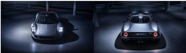
Gordon Murray Automotive hat den betörend schönen T.33 vorgestellt; das zweite Modell von GMA nach dem 2020 eingeführten T.50. Mit zwei statt zuvor drei Sitzen, einem als Mittelmotor installierten 3,9-Liter-V12 von Cosworth, der 615 PS leistet und bis 11.100 U/min dreht, und einem Gewicht von unter 1100 Kilogramm will der Ex-Brabham-, Ex-McLaren-Designer die Messlatte für moderne Supersportwagen nochmals höher legen.
