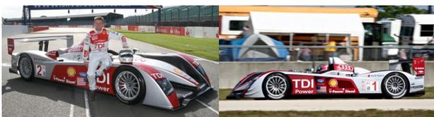
Aber wie das so oft der Fall im Motorsport war, hatte dieser spezielle Audi großen Anteil an der Entwicklung der Markenmodelle, die um die Jahrtausendwende entstanden – sein Kraft bezog er nämlich nicht aus einem hochdrehenden und hochgradig durstigen Benzinrennmotor, sondern einem Drehmomentmeister von einem V12-Dieselaggregat.
