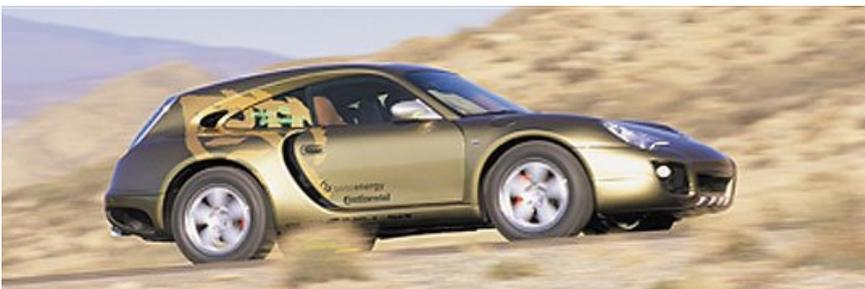
Die Linienführung des Bedouin erinnert sehr an den Porsche 911 des Typs 996 von welchem auch die allradgetriebene Bodengruppe stammt. In der Tradition des sportlichen Kombis flacht sich die Dachlinie nach hinten dynamisch ab. Die breiten hinteren Kotflügel mit ihren markanten Lufteinlässen versprühen Kraft pur. Die großen vorderen Lufteinlässe tragen ebenfalls zur kraftvollen Ausstrahlung des Bedouin bei.
