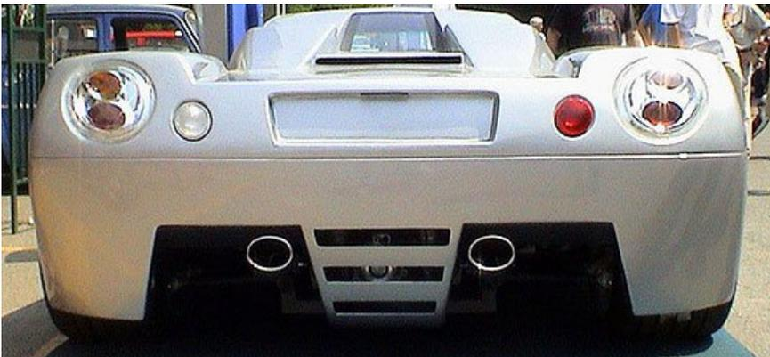
Der Covini C6W bleibt trotz seiner zweiten Achse mit nur 4,18 Metern Länge sehr kompakt. Die übrigen Maße folgen denen eines echten Supersportwagens: 1,99 Meter Breite und nur 1,08 Meter Höhe. Der Audi-V8-Motor leistet 380 PS und 450 Nm Drehmoment und treibt den 1.150 Kilogramm leichten C6W auf eine Höchstgeschwindigkeit von 300 km/h. Die Kraftübertragung erfolgt über ein Sechsgang-Getriebe an die Hinterräder.
