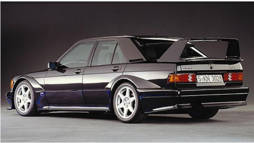
Schon äußerlich fällt der Evo II mit seinen Karosseriemodifikationen auf, die den Luftwiderstand weiter verringern und den Anpressdruck an Vorder- und Hinterachse erhöhen. Besonders markant ist der große Heckspoiler, aber auch die Kotflügelverbreiterungen sorgen für Aufmerksamkeit.
