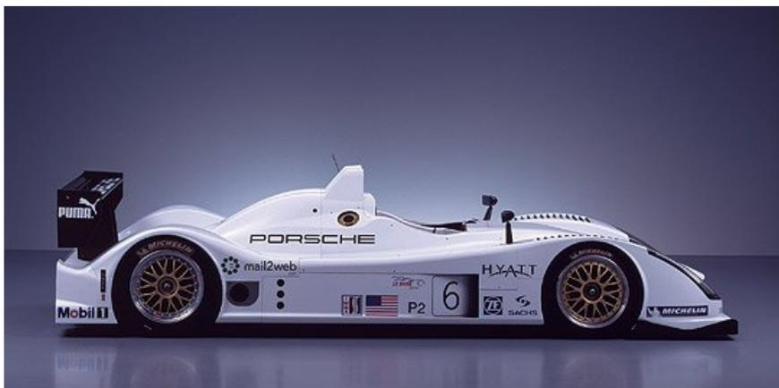
Angetrieben wird der Prototyp von einem neu entwickelten 90-Grad-V8-Langstrecken-Rennmotor, der mit einem vom Regelement vorgeschriebenen Luftmengenbegrenzer ausgestattet ist und aus 3,4 Litern Hubraum eine Leistung von 480 PS holt. Das Aggregat zeichnet sich durch ein geringes Gewicht sowie einen besonders tief liegenden Schwerpunkt aus. Der Vierventiler verfügt über eine Trockensumpfschmierung und Einzeldrosselklappen.
