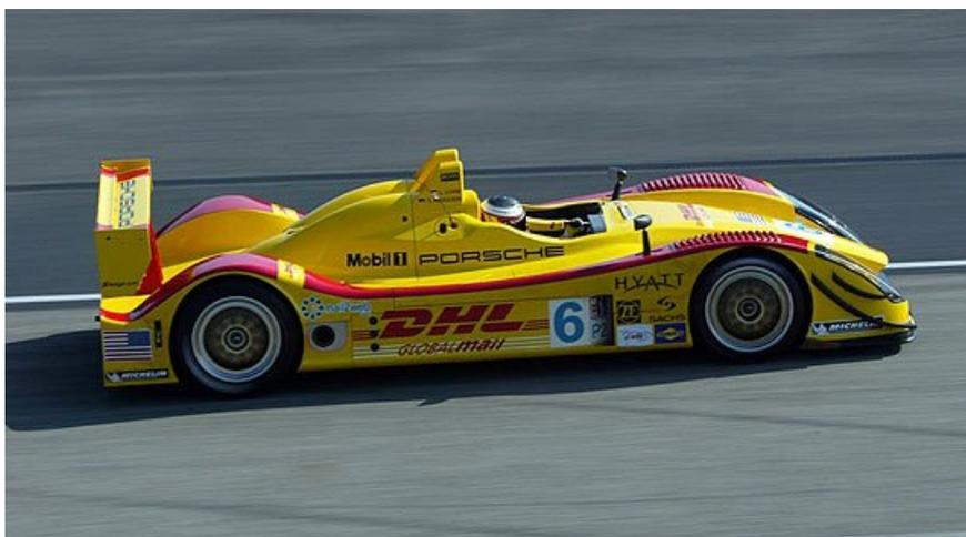
Porsche entwickelte den RS Spyder für Kunden-Einsätze in der American Le Mans Series. Angetrieben von einem neuen 3,4-Liter-V8 Langstrecken-Rennmotor mit 480 PS, erreicht der Sportprototyp dank eines integrierten Leichtbau-Konzepts exakt das vorgeschriebene Mindestgewicht von nur 750 Kilogramm.
