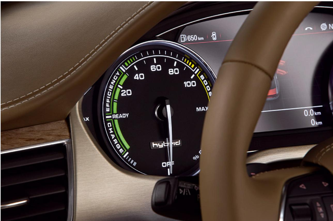
Außerdem gilt die Studie als Grundlage für die Technik-Architektur eines künftigen Audi Serienhybridmodells – dem Audi Q5 Hybrid, der laut Audi noch 2010 vorgestellt wird. Beide Modelle zeichnen sich dadurch aus, dass sie allein mit dem Benzin- oder mit dem Elektromotor fahren oder die Kraft beider Antriebe kombinieren können. Der Hybridantrieb erlaubt elektrisches Fahren bis 65 km/h mit mehr als zwei Kilometer Reichweite und damit genug für den Stop-and-Go-Verkehr in der Stadt.
