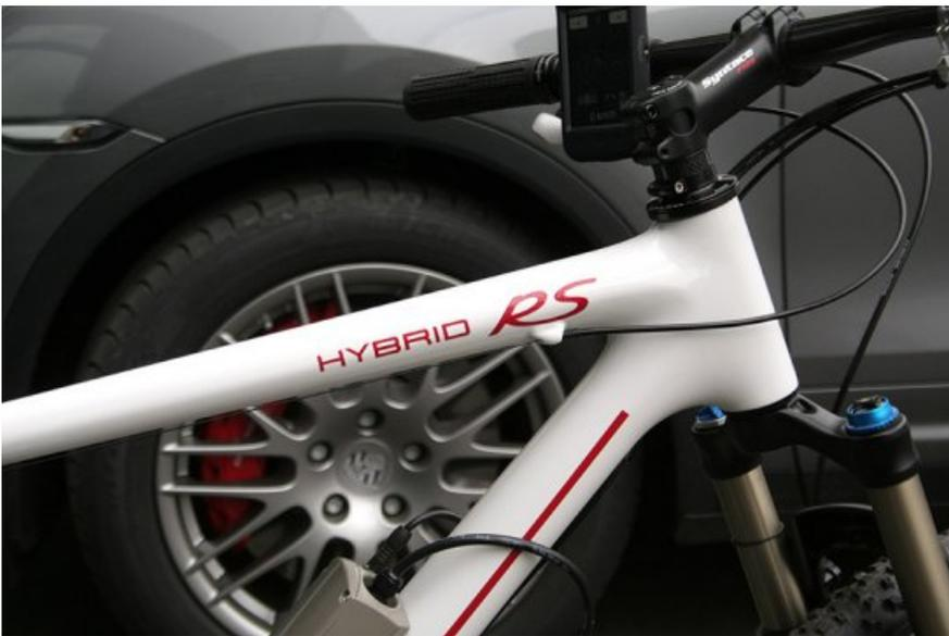
Zur Technik: Im Hinterrad steckt ein elektrischer Nabenmotor mit Direktantrieb, der ohne zusätzliches Getriebe bis zu 450 Watt die Straße bringen kann. Geregelt wird der Antrieb per Drehmoment-Sensierung, das bedeutet, sobald der Fahrer in die Pedale tritt, bekommt er zusätzliches Drehmoment über den Antrieb am Hinterrad. Durch elektrische Rekuperation führt das Hybridsystem bei Bergabfahrt Ladung für das Batteriepaket zurück.
